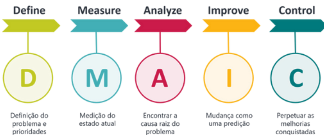
Figura 1. Representação gráfica do modelo DMAIC (Define-Measure-Analyze-Improve-Control).
